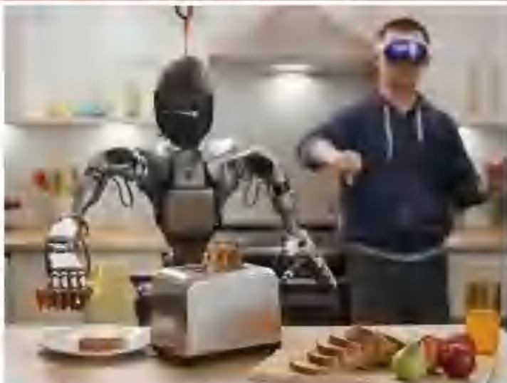
图表22: 使用Apple Vision Pro为操作员提供第一人称视角控制的人形机器人
